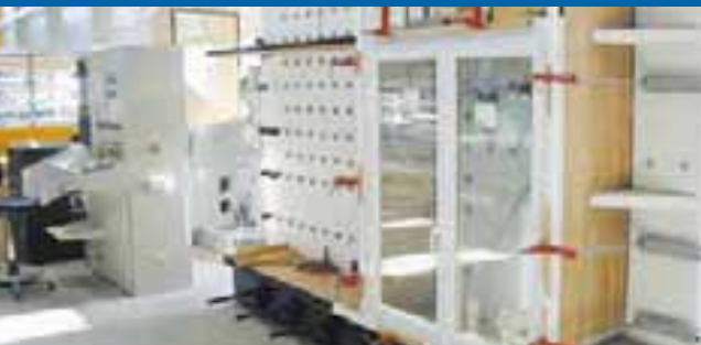
Tests de traçabilité : banc d'essais AEV (Air - Eau - Vent).
