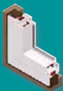
SOLUTION 1 Dormant avec tête.ière. Recouvrement de 40 mm.
