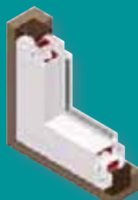
SOLUTION 6 Dormant avec aile de 30 mm. Aile compensée de 10 mm. Compensateur de feuillure de 13 mm. Recouvrement total de 30 mm.
