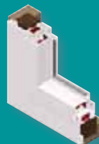
SOLUTION 6L Dormant avec compensateur de feuillure de 13 mm. Recouvrement total 70 mm.
